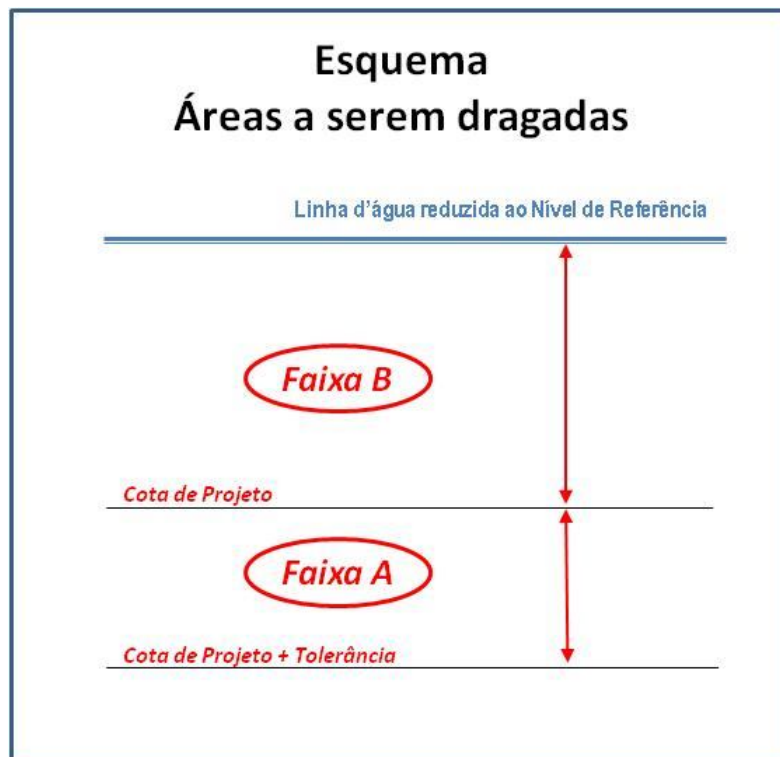
Figura 2 – Especificação das profundidades nas faixas
