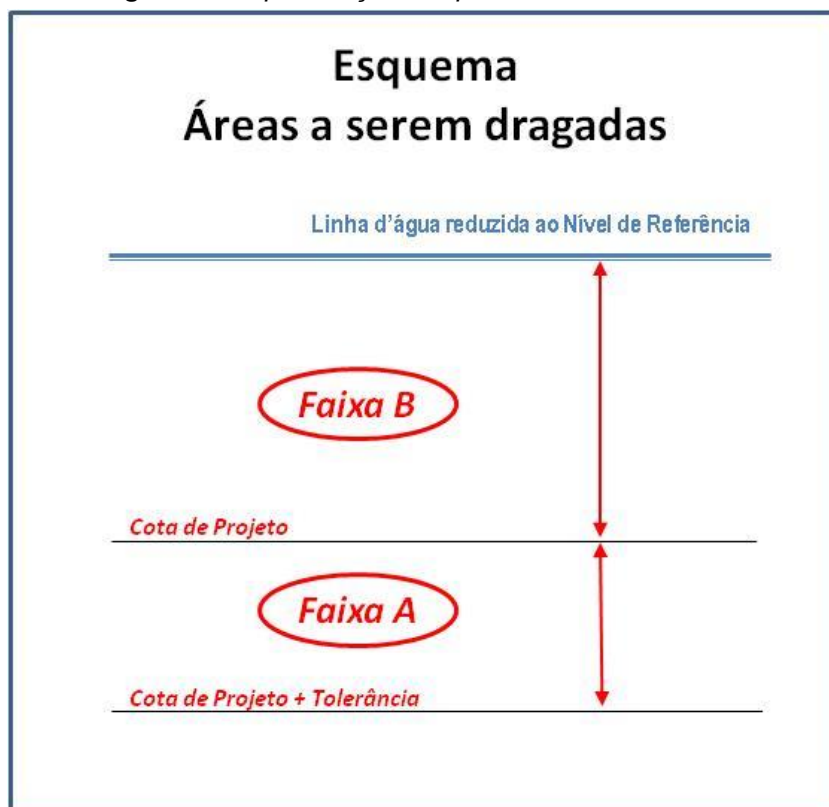
Figura 2 – Especificação das profundidades nas faixas
