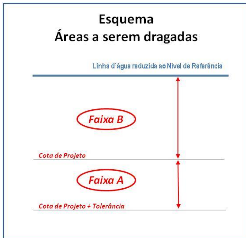
Figura 2 – Especificação das profundidades nas faixas
