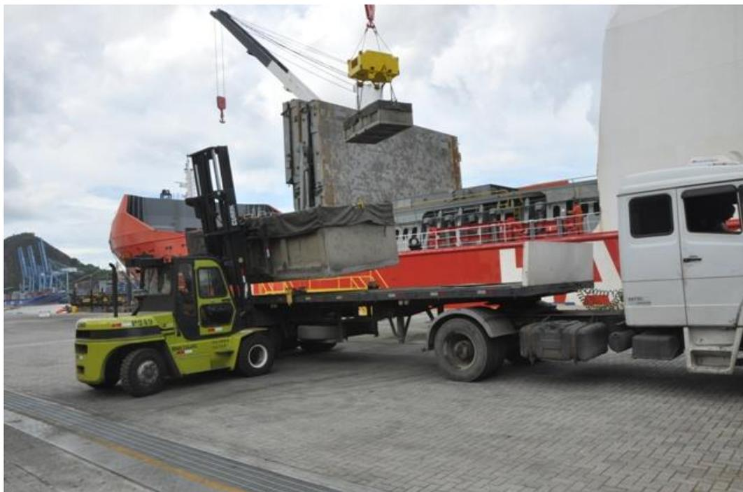
**Figura 28.** Embarque de Concentrado de Cobre Utilizando Guindastes de Bordo
