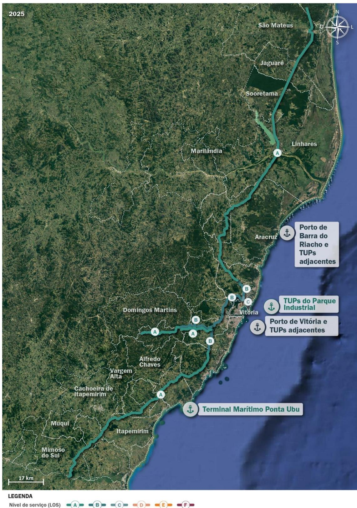
Figura 178 – LOS dos segmentos da BR-101 e BR-262 em 2025 após o acréscimo de nova faixa viária em ambos os sentidos das rodovias
