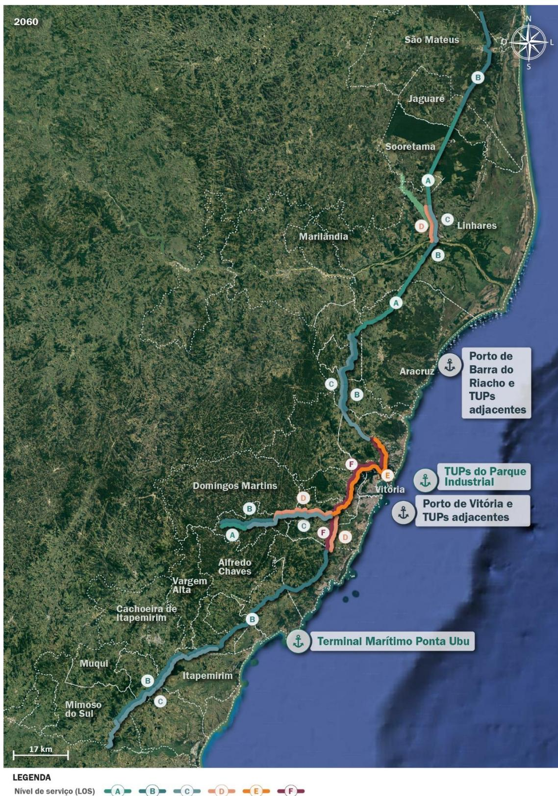
Figura 180 – LOS dos segmentos da BR-101 e BR-262 em 2060 após o acréscimo de nova faixa viária em ambos os sentidos das rodovias
