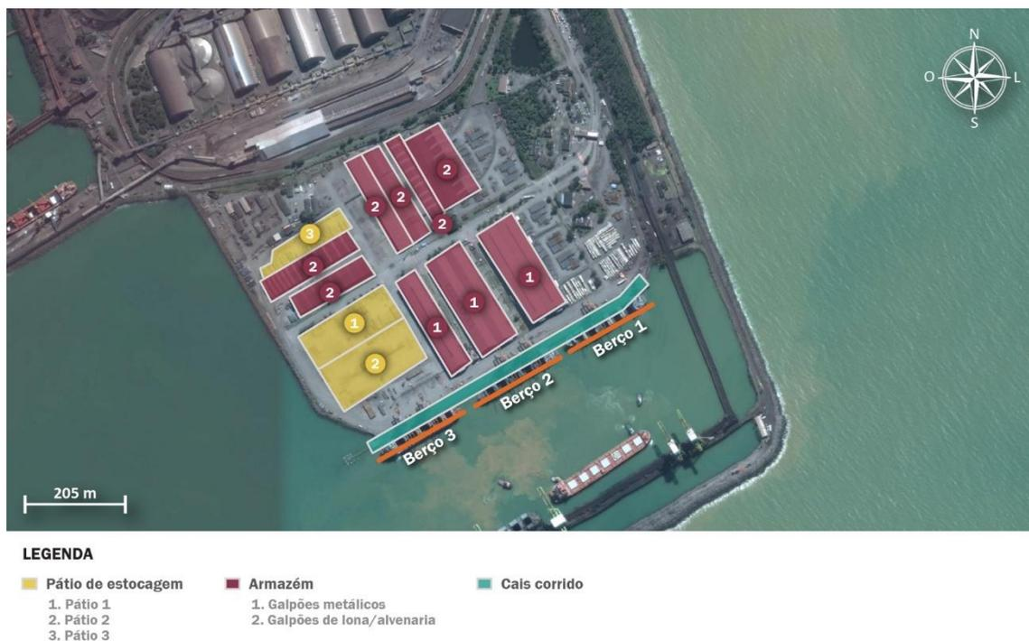
Figura 60 – Infraestrutura de acostagem e armazenagem do Terminal Marítimo de Praia Mole
