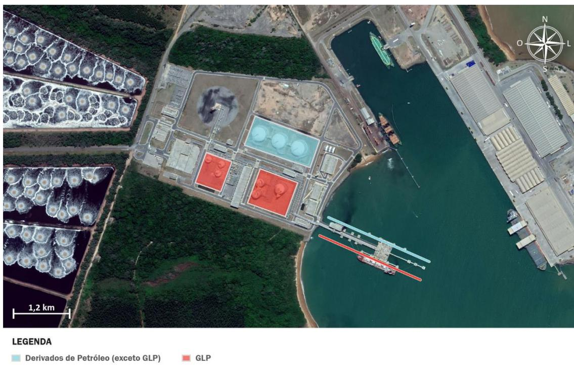
Figura 84 – Principais destinações operacionais dos trechos de cais e armazenagem do Terminal Aquaviário de Barra do Riacho
