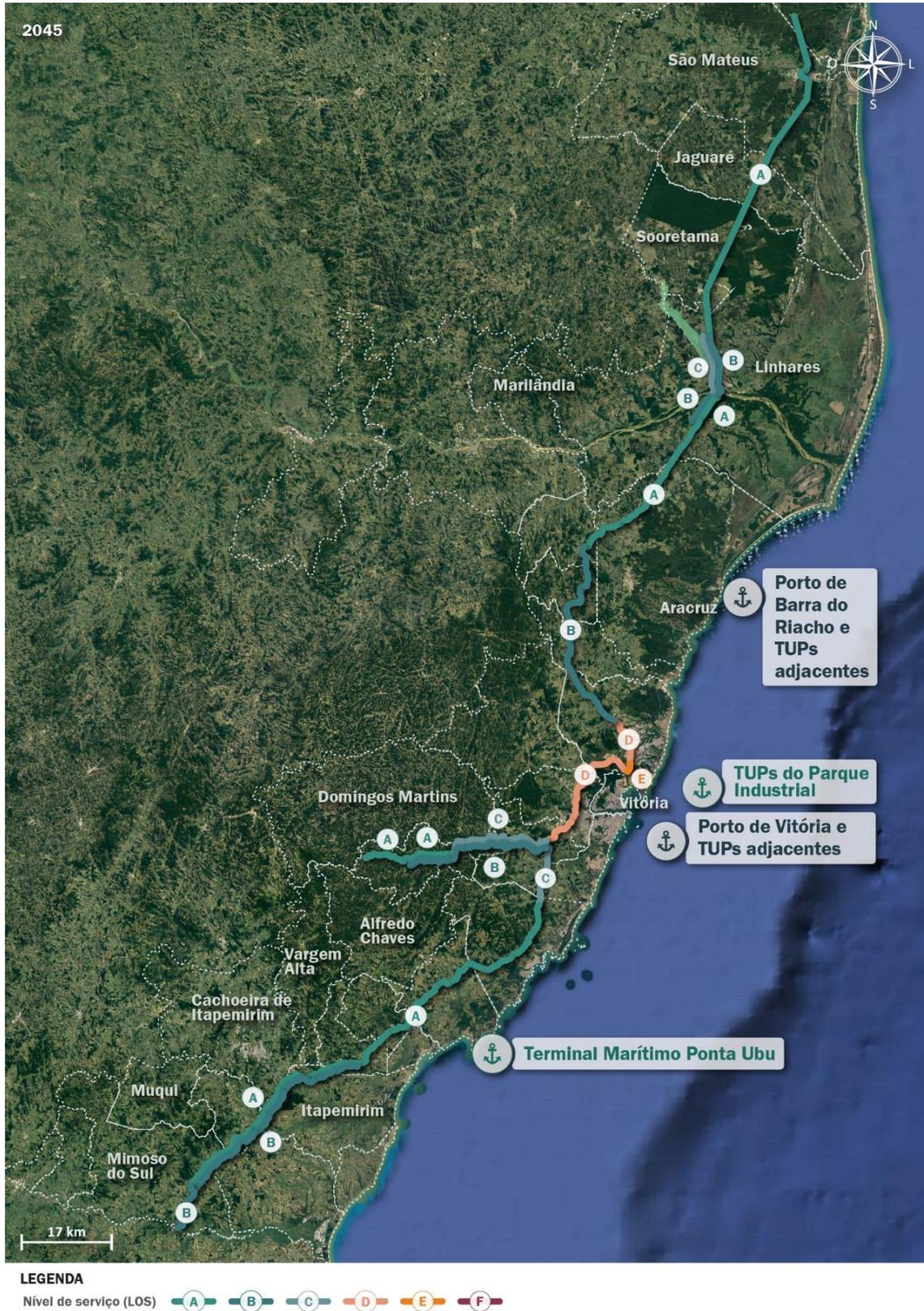
Figura 179 – LOS dos segmentos da BR-101 e BR-262 em 2045 após o acréscimo de nova faixa viária em ambos os sentidos das rodovias
