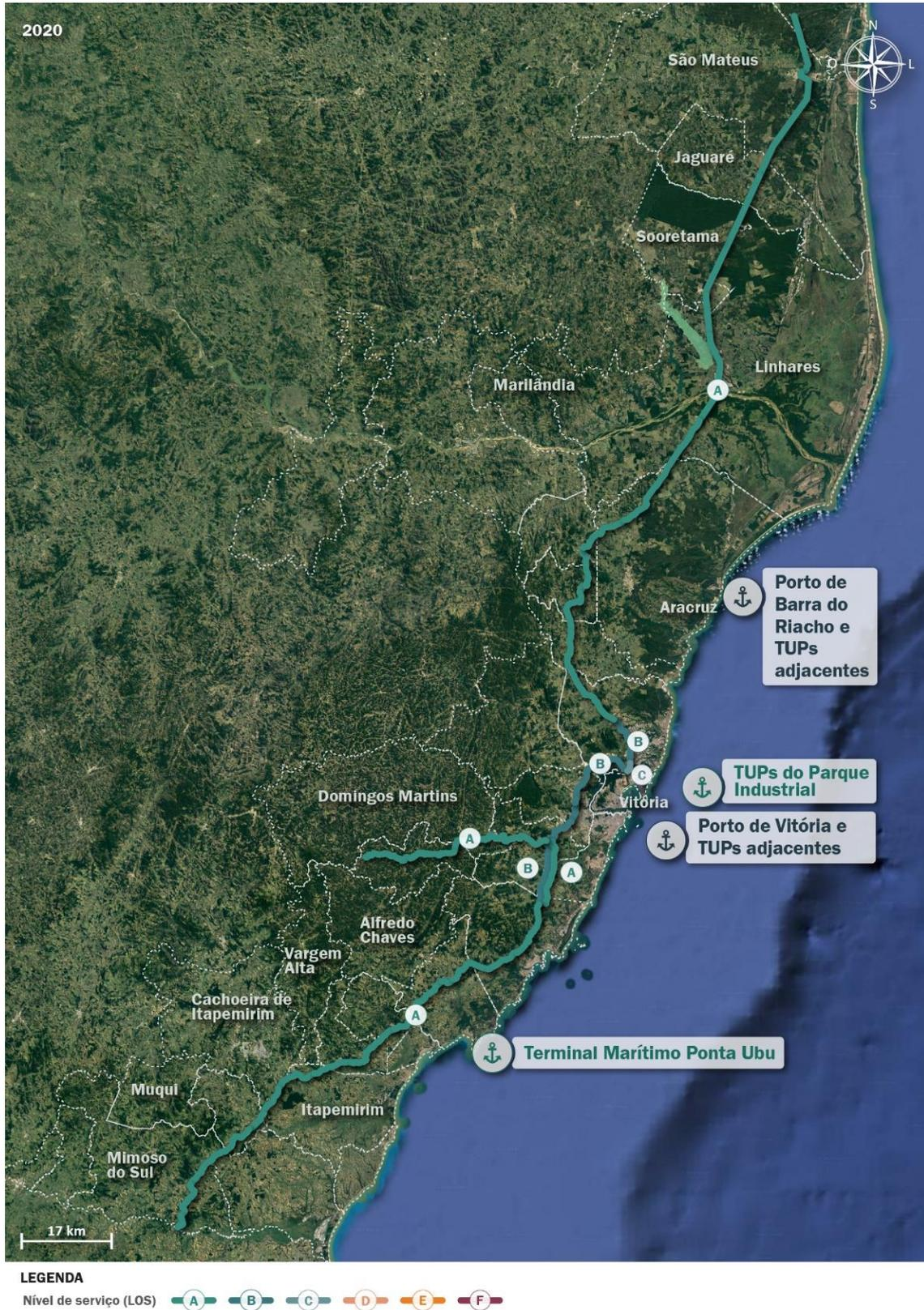
Figura 177 – LOS dos segmentos da BR-101 e BR-262 em 2020 após o acréscimo de nova faixa viária em ambos os sentidos das rodovias
