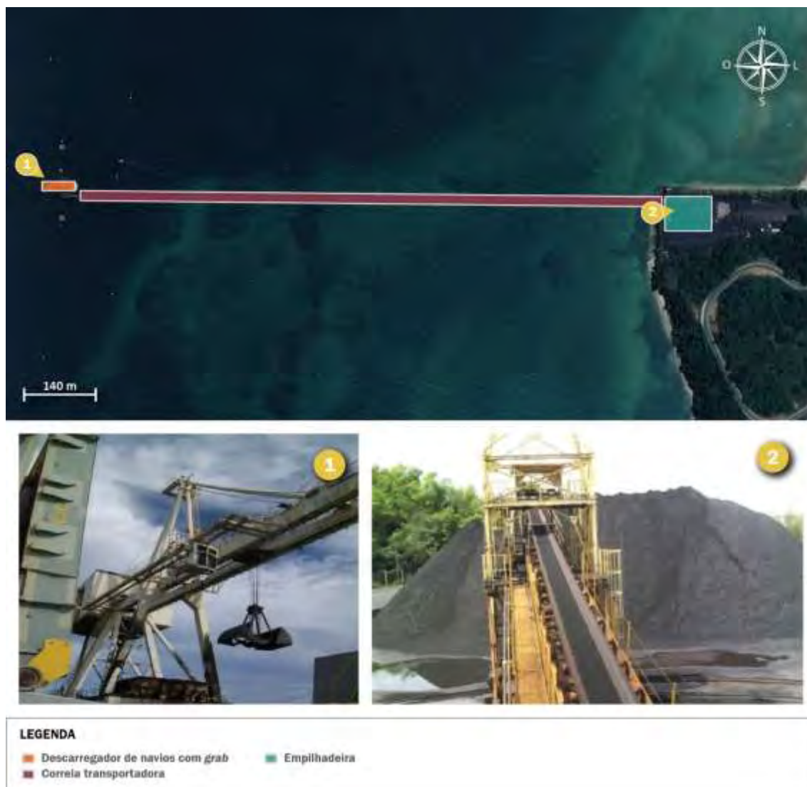
Figura 57 – Equipamentos do TUP Gerdau
