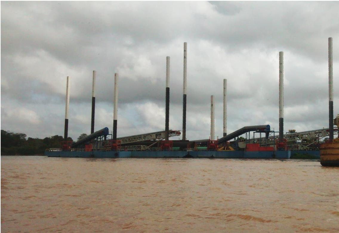
Figura 11 – Plataforma elevada tipo *jack-up* no Terminal Privativo Zamin Ferrous Sistema Amapá
