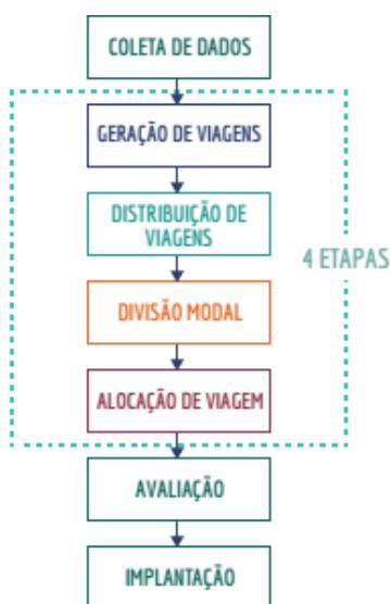
Figura 122 – Fluxograma de estudo para planejamento de transportes
