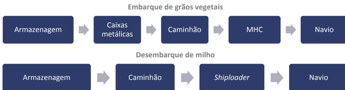
Figura 64 – Fluxograma das operações de embarque de soja e milho.
