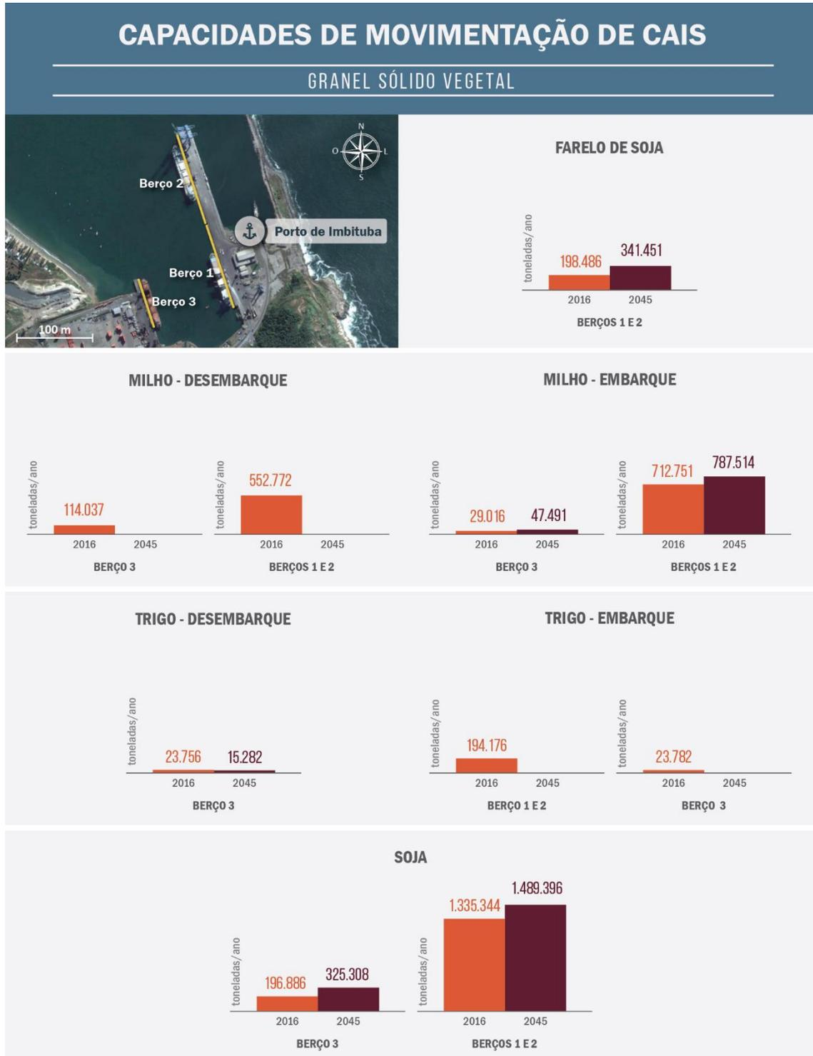
Figura 112 – Capacidade de movimentação de granéis sólidos vegetais por trecho de cais no Complexo Portuário de Imbituba
