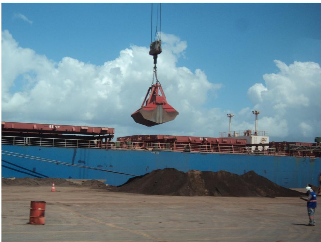
Figura 27. Embarque de Minério de Ferro por Guindaste com Grab Fonte: LabTrans
