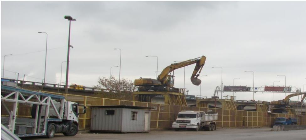
**Figura 82.** Transferência do Ferro Gusa do Trem para Caminhão por Meio de Tratores Montados sobre Plataformas
