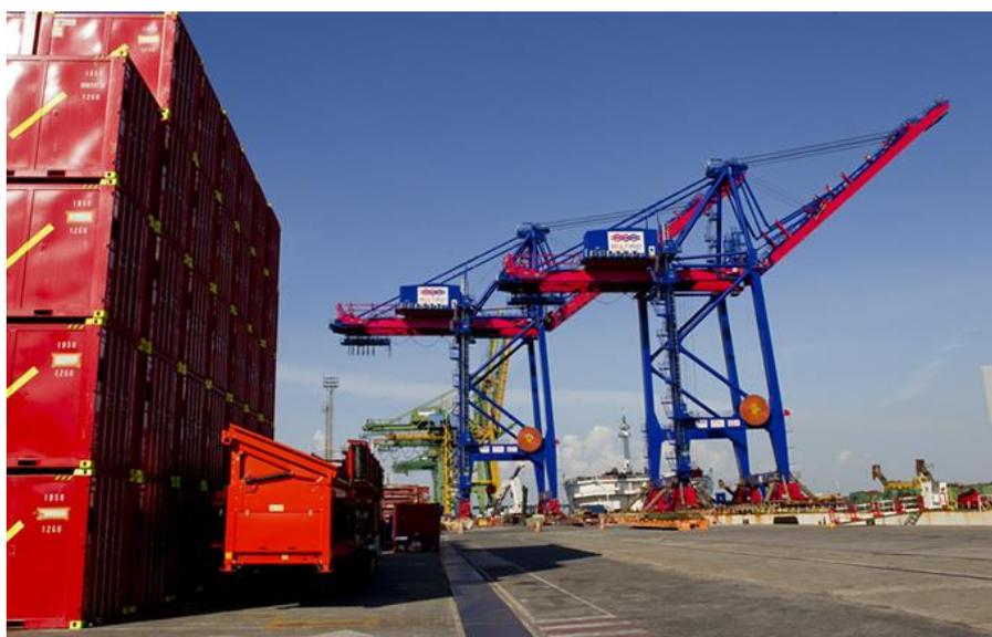
**Figura 51.** Portêineres *Tandem-Single Hoist* da Multiterminais
