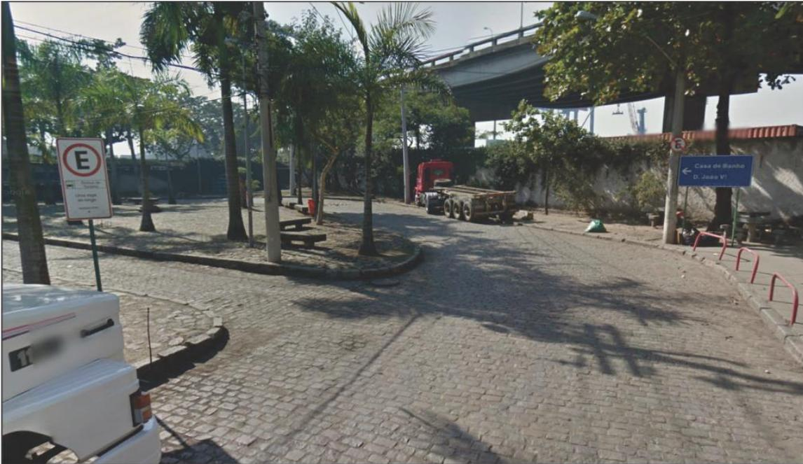
**Figura 11.** Curva com Raio Inadequado para o Tráfego de Caminhões
