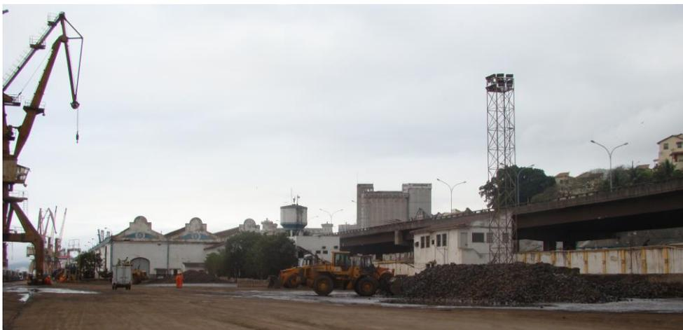
**Figura 83.** Recuperação da Pilha de Ferro Gusa por Pá Carregadeira
