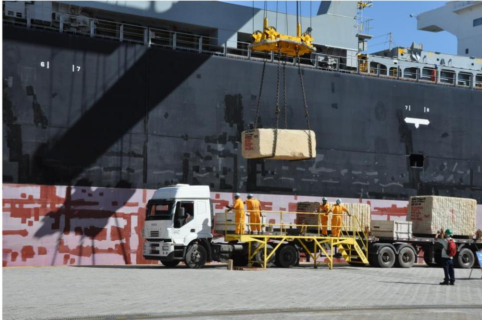
**Figura 112.** Embarque de Blocos de Granito Utilizando Guindastes de Bordo
