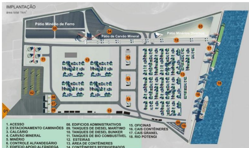
Figura 79. Projeto Conceitual de Expansão do Porto de Natal na Margem Esquerda do Rio Potengi
