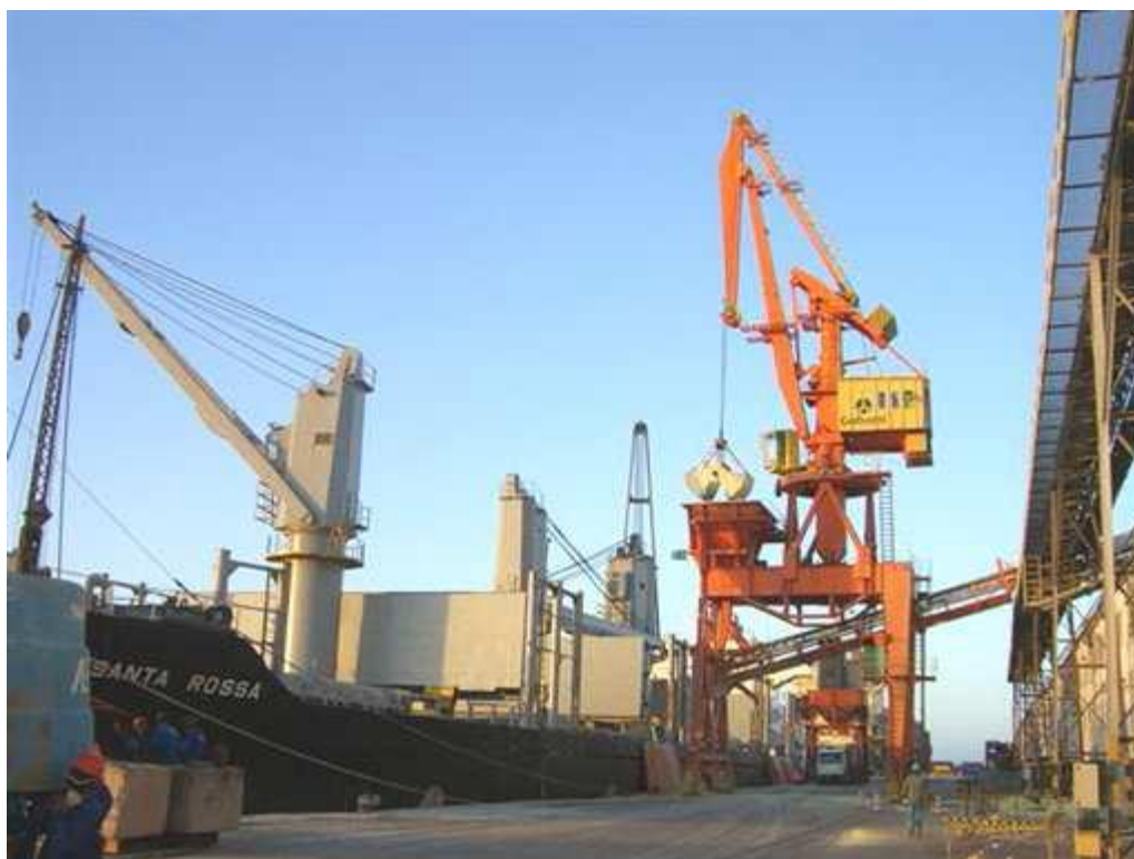
Figura 111. Desembarque de Fertilizantes no Porto do Mucuripe com o Uso do Guindaste de Cais Tipo Canguru
