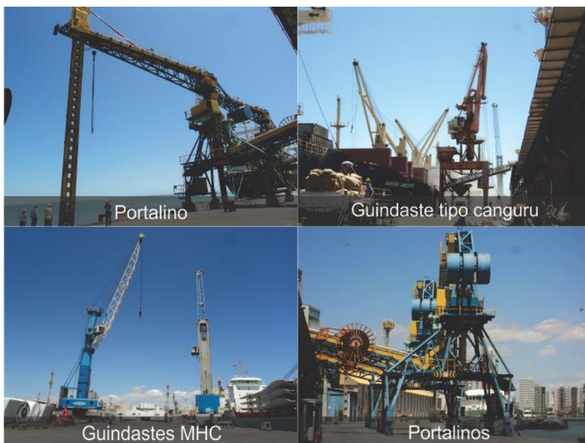
Figura 12. Equipamentos de Cais do Porto do Mucuripe
