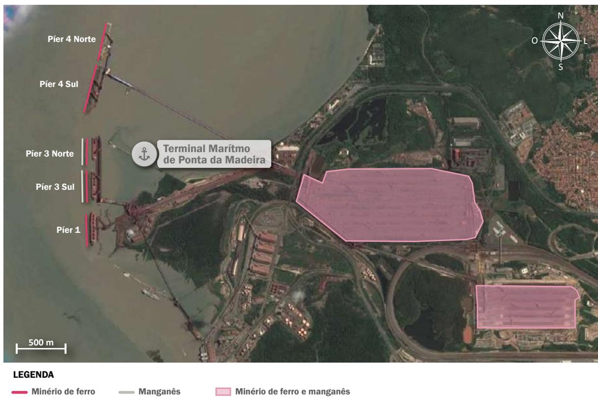
Figura 6 – Estruturas de acostagem e armazenagem do TPM. Fonte: Google Earth (2016). Elaboração: SNP/MTPA (2017)
