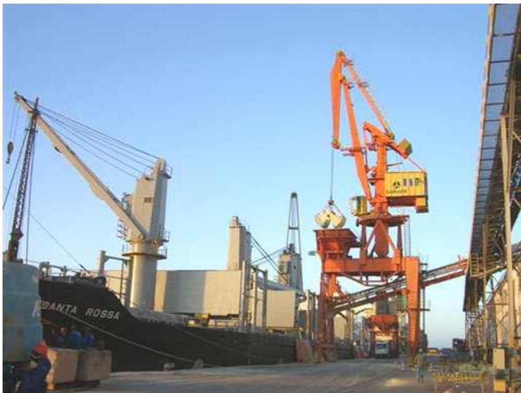
Figura 31. Desembarque de Fertilizantes no Porto do Mucuri com o Uso do Guindaste de Cais Tipo Canguru
