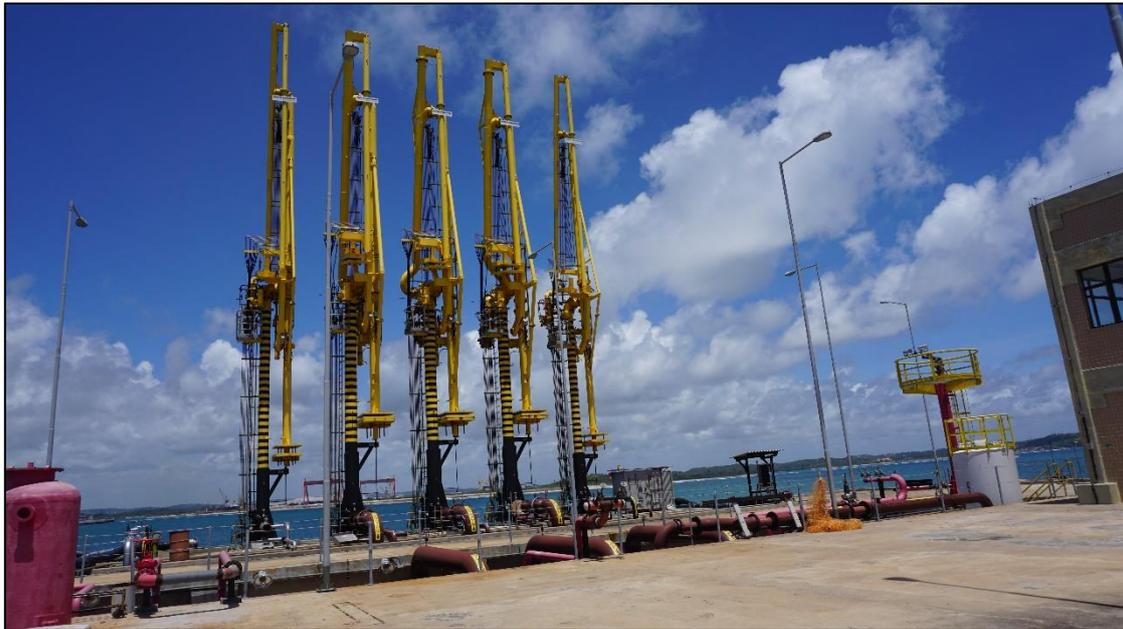
Figura 17 - Braços mecânicos do Píer de Granéis Líquidos 3B
