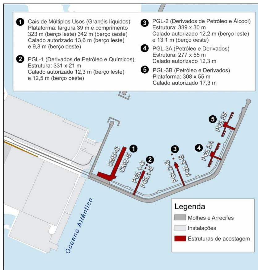
Figura 8 - Instalações de acostagem do porto externo.
