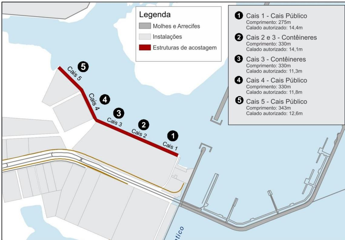
Figura 19 - Instalações de acostagem do porto interno.
