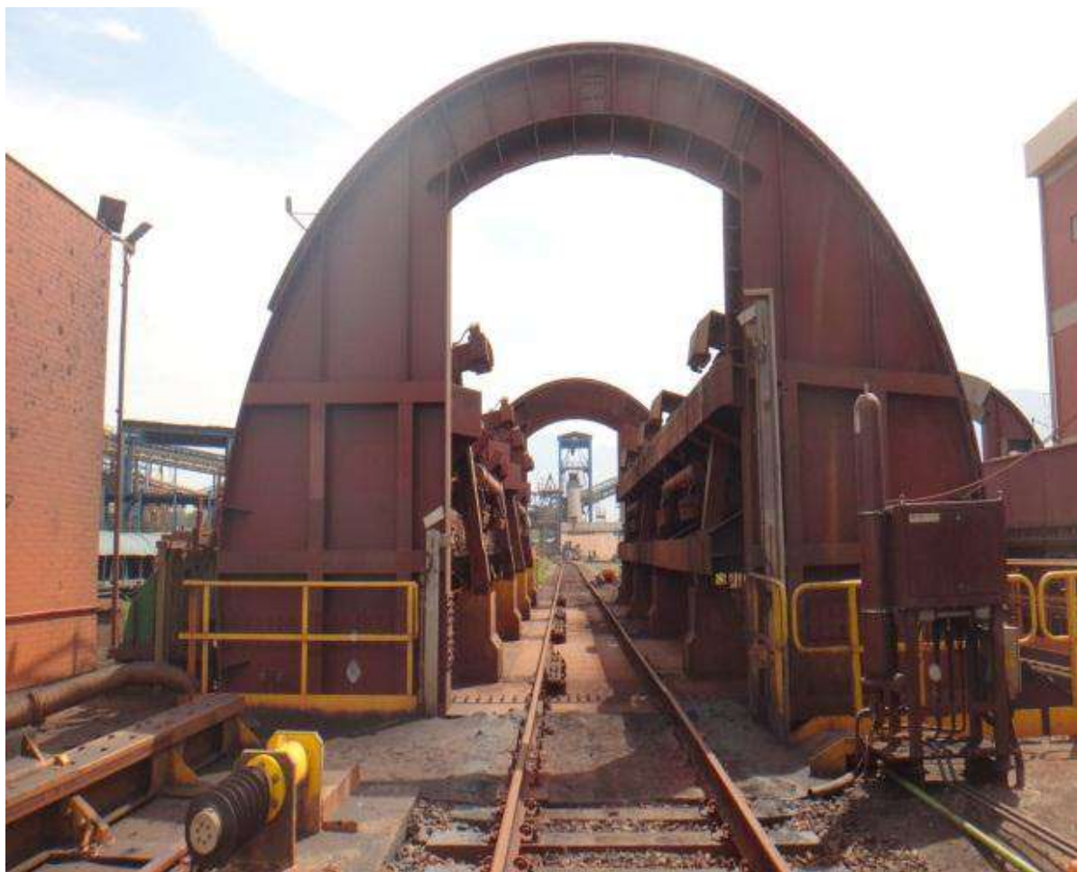
Figura 16 - Virador de Vagão
