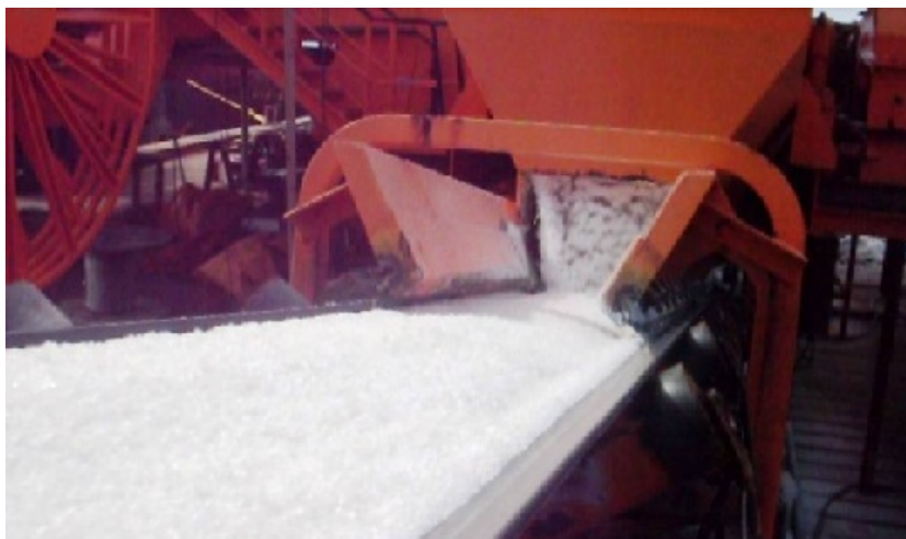
Figura 23 – Saída do sal das moegas seguindo para esteira
